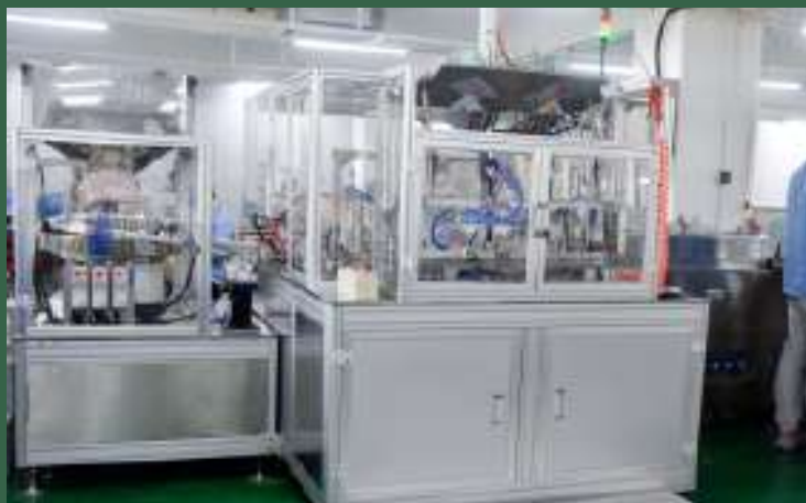
自動加嘴設備
